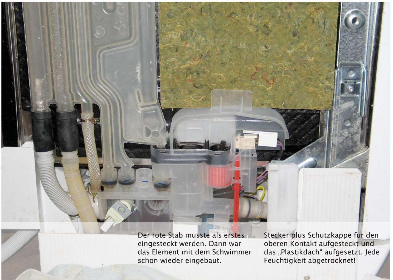
Der rote Stab musste als erstes eingesteckt werden. Dann war das Element mit dem Schwimmer schon wieder eingebaut.
