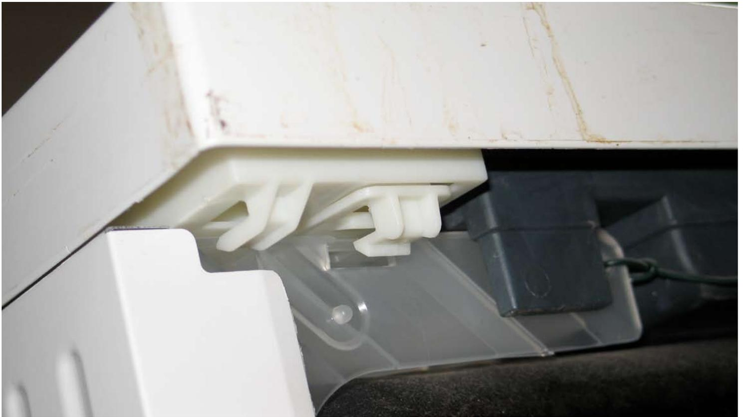
Die Bosch Spülmaschine bzw. der Geschirrspüler SGS45E22EU/56 blieb im Programm beim abpumpen hängen. Ein Tip aus dem Forum: Schläuche reinigen
